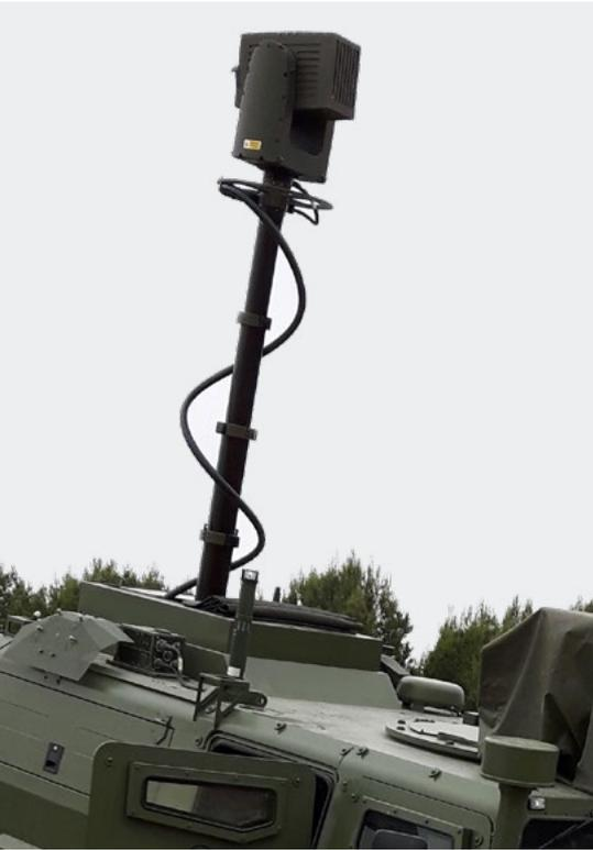
Le **MECMAST** électromécanique offre une combinaison unique de force de levage, de robustesse, de fiabilité et de haute précision.
