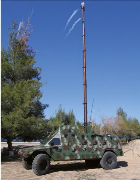
Les mâts pneumatiques avec systèmes de verrouillage peuvent être maintenus étendus pendant de longues périodes sans pression d'air interne. Les mâts **SUPER STEADY FULL AUTOMATIC**, **SUPER STEADY SEMI-AUTOMATIC**, **SUPER STEADY** et **STEADY** répondent aux exigences les plus exigeantes des systèmes de communications mobiles, de renseignement, de surveillance et de sécurité pour les applications militaires.
