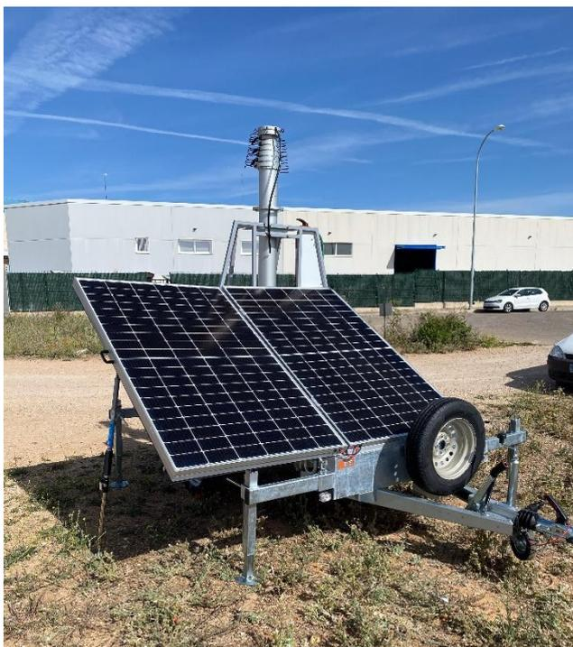
La structure porteuse sera fixe, non réglable en inclinaison, avec un angle de 30° pour optimiser l'utilisation de la radiation solaire.
