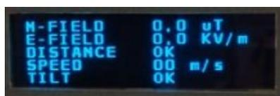
Menu affichant la vitesse de vent, la tension, le magnétisme, la distance, l'inclinaison
