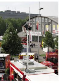
Le modèle de mât ROOF PLUS PRO est composé d'un tube principal de 90mm ou 115mm de diamètre et est équipé d'un système de rotation et d'inclinaison de type NOVA 12V ou 24V, d'un micro-interrupteur, d'une télécommande multifonctions et d'une carte électronique.
