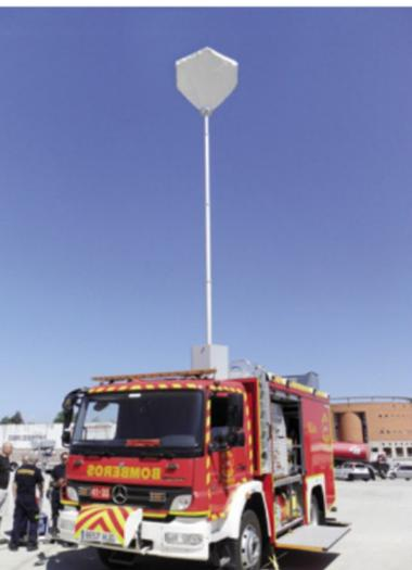
Le ballon d'éclairage **LUMICONE**, produit breveté FIRECO, est un système innovant destiné à être installé sur un mât télescopique FIRECO. Pas besoin de le monter ou de le démonter.
