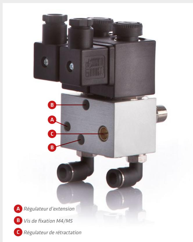
Le système de vanne Solénoïd est utilisé pour assurer l'extension électronique et la rétraction du mât. Il est fait d'aluminium anodisé et fonctionne à partir de 12V DC à 230V AC, il est donc très adaptable. En outre, il peut facilement être relégué à une autre position.
