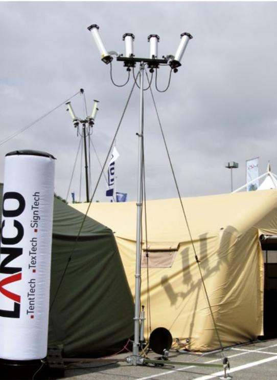
Le trépied breveté Fireco permet la mise en œuvre facile et rapide des mâts STAR, ENTRY, SUPER ENTRY, PRIMO, SUPER PRIMO et MAXI PRIMO sur tous types de terrain et avec une mise à niveau par le biais de pieds réglables jusqu'à 15°.
