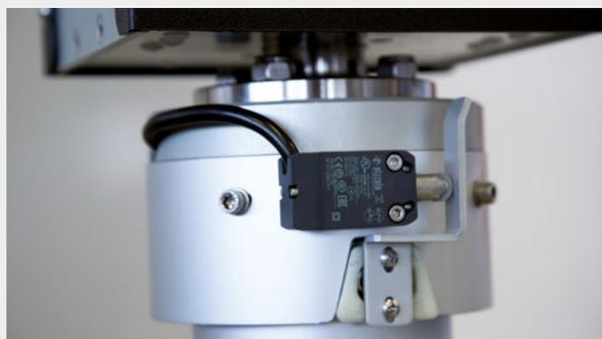
La fonction du micro-interrupteur est de vous signaler lorsque le mât est déployé. Le client peut le connecter à un signal visuel ou sonore à l'intérieur du véhicule pour éviter de conduire avec un mât encore déployé. De plus, la fonction de mise en veille peut être connectée au système de frein à main. Dès lors que le frein à main est relâché, le mât retourne automatiquement en position "descente".
