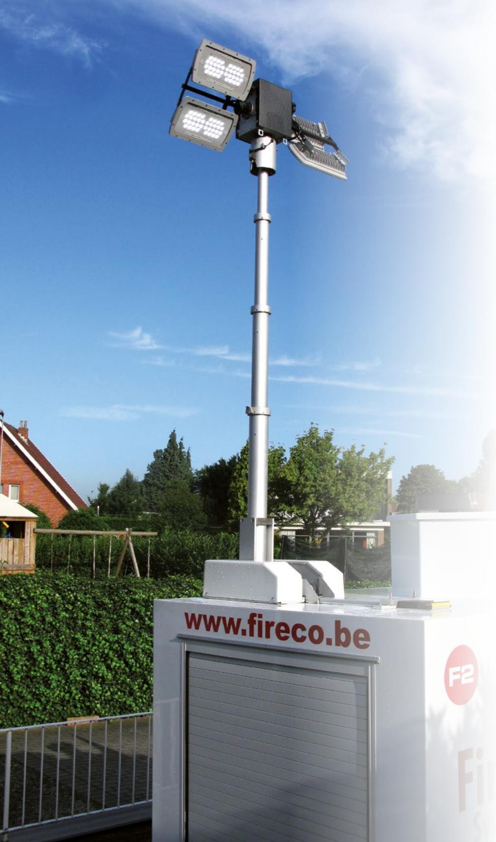
Les mâts télescopiques ROOF ont été étudiés pour être montés sur le toit afin de laisser libre l'espace interne du véhicule. Le mât ROOF T/T est doté d'une tête combinée 12/24 V, pour la rotation et l'inclinaison des projecteurs avec, soit une télécommande filaire, soit avec une télécommande hertzienne multifonctions, pour gérer chaque phase d'utilisation du mât : montée, descente, rotation, inclinaison, allumage/ extinction des projecteurs.
