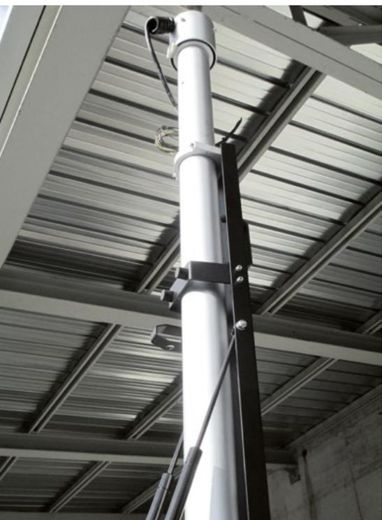
Le mât manuel Roof est une très bonne solution lorsqu'il y a peu de place à l'intérieur du véhicule. Le mât peut être facilement monté sur le toit du véhicule et peut être incliné à 90°, manuellement ou électriquement. La version manuelle est très simple et facile. Le mât est adapté pour les petites rampes d'éclairage et d'autres équipements légers.
