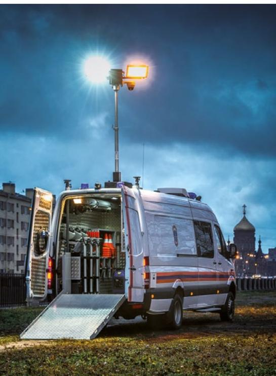
Le modèle de mât ROOF est composé d'un tube principal de 64mm et 77mm de diamètre et est équipé d'un système de rotation et d'inclinaison de type NOVA 12V ou 24V, d'un micro-interrupteur, d'une télécommande multifonctions (voir page 204), d'un tableau électronique et d'un compresseur intégré. Nous pouvons fournir une télécommande sans fil ou une télécommande intelligente SMART (voir page 207) en option.
