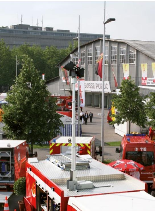
Le modèle de mât ROOF PLUS PRO est composé d'un tube principal de 90mm ou 115mm de diamètre et est équipé d'un système de rotation et d'inclinaison de type NOVA 12V ou 24V, d'un micro-interrupteur, d'une télécommande multifonctions et d'une carte électronique.
