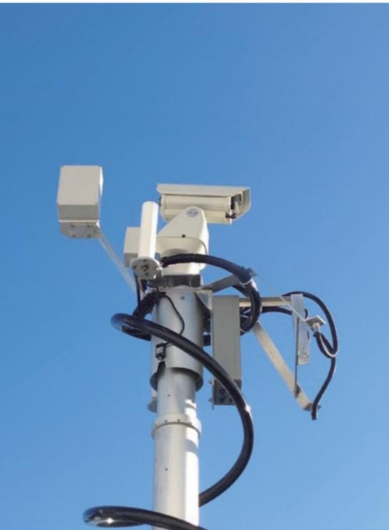
Le **GUARDIAN** est un dispositif électronique multi-capteurs qui peut être monté sur les mâts télescopiques FIRECO et qui se compose de deux parties: un dispositif de détection qui est monté au-dessus du mât et un automate programmable avec un écran d'alarme.
