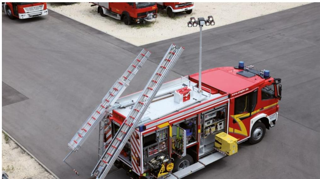
Les mâts Lourds peuvent également être fabriqués dans la **VERSION COMPACT** lorsque la hauteur rétractée doit être plus courte. La version Compact permet d'avoir la même hauteur déployée que le mât Lourds, mais avec une hauteur rétractée plus courte.
