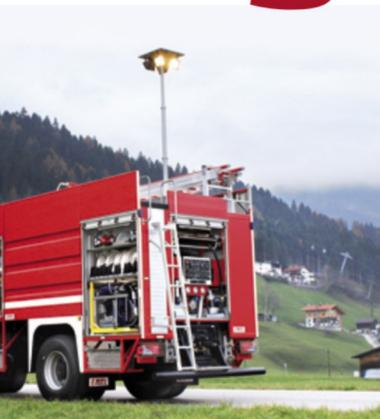
Le mât télescopique **LIGHT** a un diamètre de 90mm et ses hauteurs déployées varient entre 2.64m et 7.944m. Ces modèles de mât sont utilisés pour les situations les plus communes, comme pour l'éclairage, la photographie, les équipements de poids moyen.
