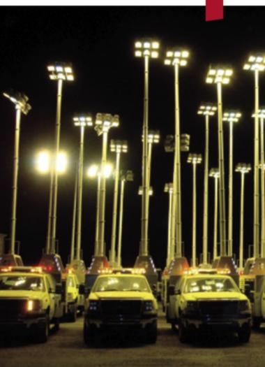
Le mât télescopique **SUPER HEAVY** a un diamètre de 200mm. Ce modèle peut porter des charges plus grandes et plus lourdes que le modèle Heavy. Il est disponible jusqu'à 12 sections et bénéficie d'un meilleur ratio entre la hauteur rétractée et déployée. Le mât Super Heavy est idéal pour monter de grandes rampes d'éclairage, de grandes antennes et de lourds équipements de mesure. Ses hauteurs déployées varient entre 6.474mm et 40.012mm.
