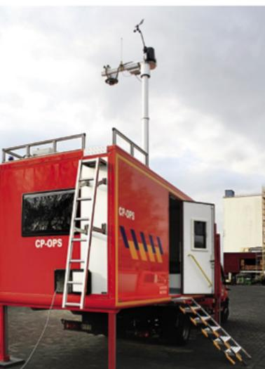
Le mât télescopique **HEAVY** a un diamètre de 152mm. Ce modèle peut porter de lourdes charges en tête de mât et est donc approprié pour supporter de grandes rampes d'éclairage, de grandes antennes et de lourds équipements de mesure. Ses hauteurs déployées varient entre 12.026mm et 14.935mm.
