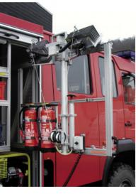
Le mât ENTRY est le premier de la gamme de mât léger avec un câble électrique interne. La hauteur déployée varie entre 2m et 4m et le mât peut être équipé d'une pompe à main manuelle. Il possède un dispositif de verrouillage sur chaque tube qui les empêche de tourner. La tête de mât comporte un trou avec molette de serrage pour axe de 24mm de diamètre.
